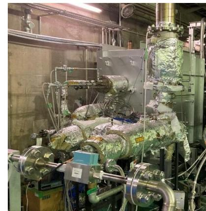
ラジアントチューブバーナ試験装置
