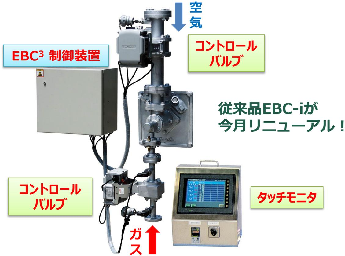
燃焼量の変動に応じて空気比を自動制御
