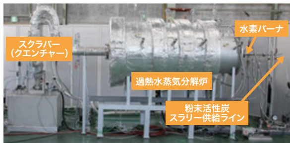
水素燃烧式高温過熱水蒸気分解処理試験装置
