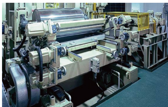
CCL1ライン内にコータは(3~10台)設置されています。
