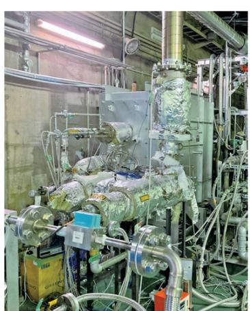
リジエネバーナ搭載試験炉
