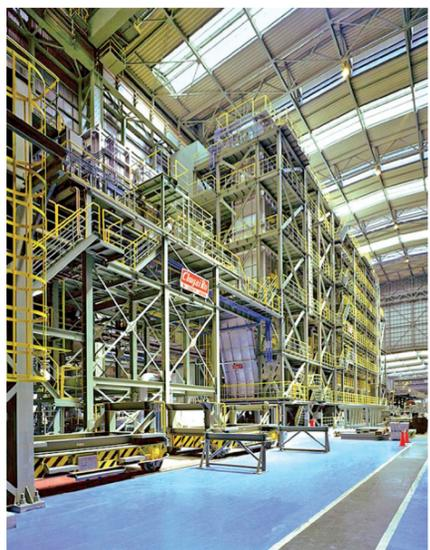
誘導加熱技術の採用が進む鉄鋼プロセス炉
