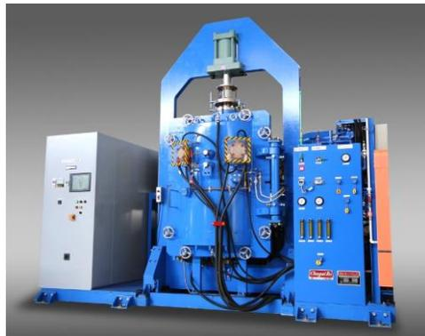
セラミックス向け高温・高圧焼成炉
