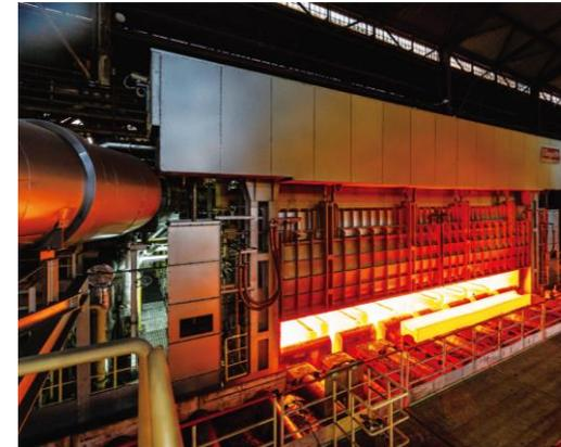
鉄鋼向け省エネ型厚板加熱炉
