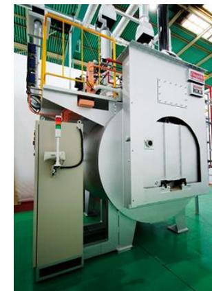
熱処理炉搭載ラジエント
