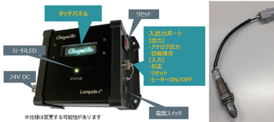
図5 Lam \mu da-i(ラムダアイ)本体とセンサー部
