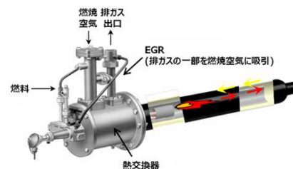
ラジアントチューブ式水素バーナ (I型間接加熱式)
