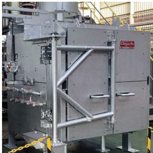
Fig.4 水素燃焼テスト炉
