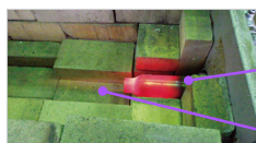
都市ガス用バーナ構造における水素燃焼時の様子
