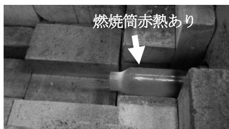
図1. 従来型バーナでの水素燃焼
