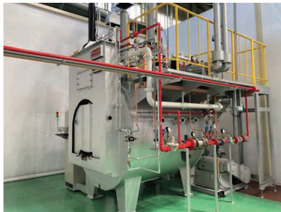
2022年4月に堺事業所に設置した ラジアンチューブ型水素燃焼実証炉
