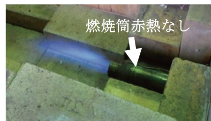
図 11 従来型バーナでの 13A 都市ガス燃焼[3]。
