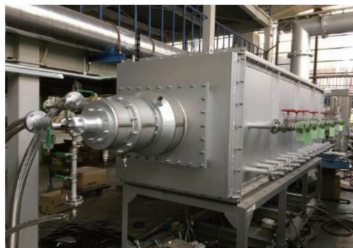
図 22 100 kW アンモニア燃焼試験設備。
