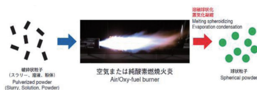
図 15 火炎による溶融・球状化の模式図[4]。
