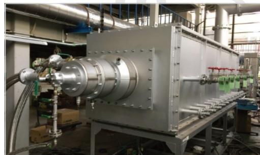
図5. 100kWアンモニア燃焼試験設備
