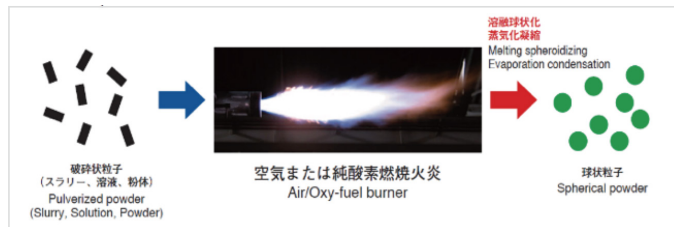
図15. 火炎による熔融・球状化の模式図 [4]
