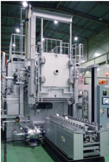
バッチ式真空浸炭炉
