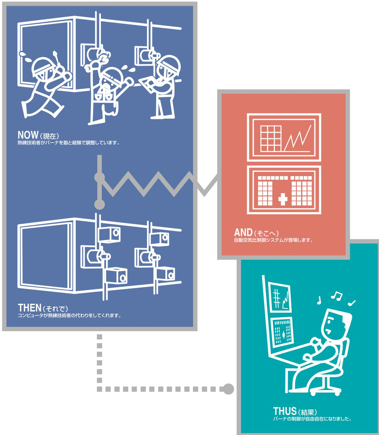
**EBC-i** はハードに市販のモジュール型調節計を採用することで従来の精密空気比制御機能を引き継いまま、空気比パターン数の大幅増加をはじめ、冷却モード運転やバーナ間引き運転など機能アップを実現しました。また、タッチモニタの画面内容も充実し、最大16ループの表示が可能となりました。
