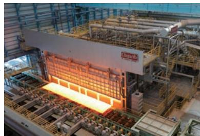
鉄鋼用加熱炉
