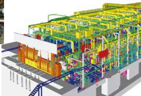
ウォーキングビーム型連続鋼片加熱炉
