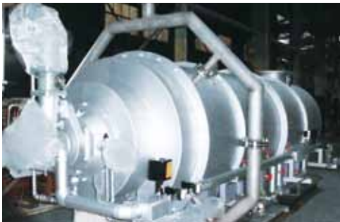
直接燃焼式脱臭装置
