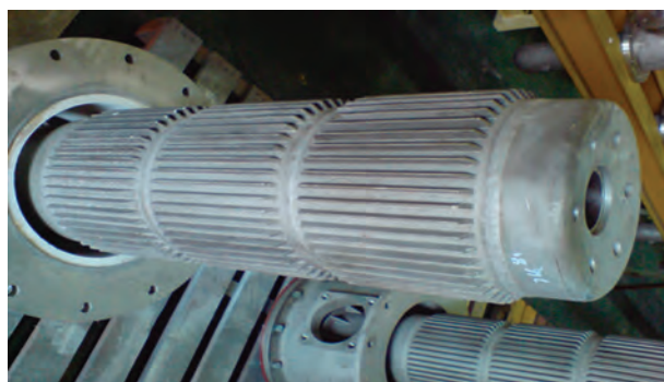
写真1 SRMG 型レキュバーナ レキュペレータ部の外観
