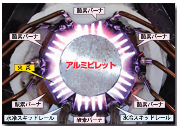
図7 インピンジ加熱を応用したアルミビレットヒーターの使用例
