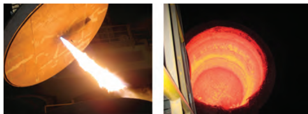
写真5 取鍋予熱用酸素バーナ（左）と予熱後の取鍋耐火物の様子（右）
