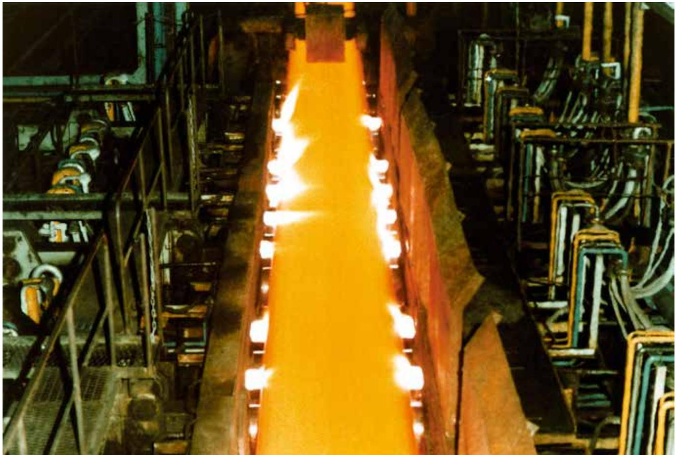
バーナノズルを多孔型にした高速高温火炎を保持できる純酸素バーナで、極部（端部）にインピングメント効果で集中的に加熱するシステムです。旋回式、昇降式などの駆動装置を採用することにより、効率的な加熱が可能です。
