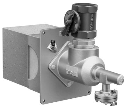
あらゆる産業界のニーズにお応えする、汎用ガスバーナの代表的機種で、空気と燃料ガスの混合をスロート部で行う中外炉工業独自のスロートミクス方式を採用しています。幅広いターンダウン比をもち、燃焼量全域にわたり最適の空気比で運転できます。
