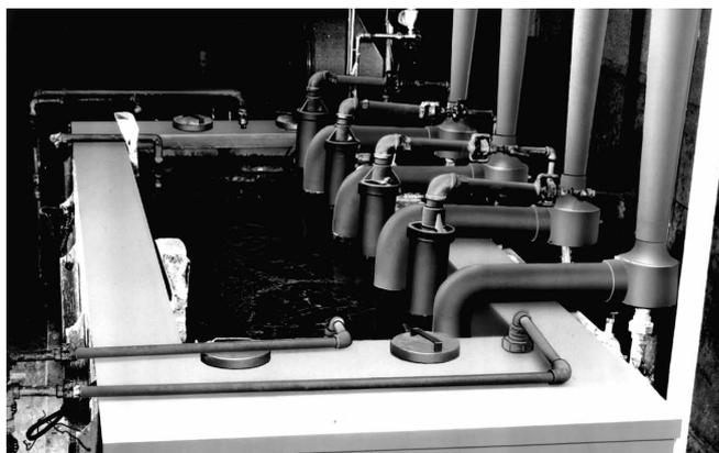
液体中に浸漬されたイマージョンチューブ内で燃料を燃焼することにより、各種の液槽、液体反応槽、低温溶融金属槽などの加熱、保熱に使用する装置です。
