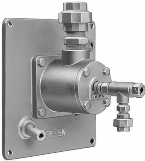
ガスと空気をバーナ先端で混合するノズルミックス式バーナです。空気に強い旋回を与えるため、火炎はバーナタイル周辺に広がるフラットな形状、いわゆるワイドフレームとなります。
