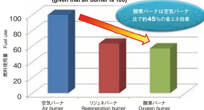
(燃料削減率は使用する耐火材、寸法および昇温温度、昇温時間によって変化します)
