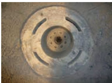
従来バーナ火炎ノズル Flame nozzles of a conventional burner
