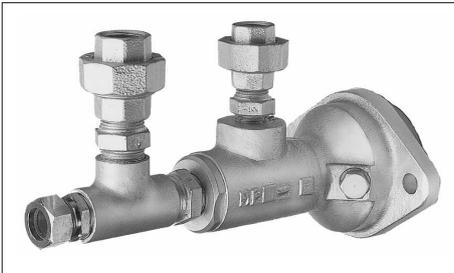
大容量のメインバーナ点火用でフランジ取付式となっているため高炉圧用にも対応できます。バーナ中心部に燃焼エアが流れる構造となっているためバーナ後部に火炎検出器が取り付けられ、確実な火災監視が行えます。また、火炎検出器のバージェアも不要で、安価な点火プラグでの電気点火により確実な点火が行えます。点火プラグは低温部にあるため高温になることがなく、焼損、カーボン付着のトラブルがありません。
