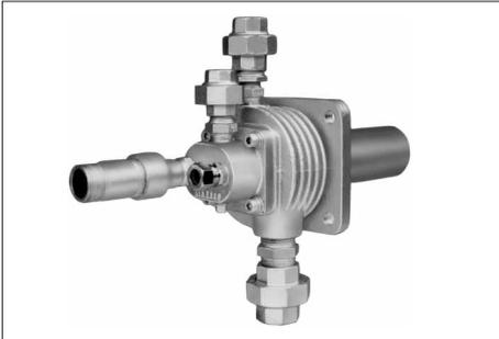
点火プラグのよりいっそうの長寿命化、メンテナンスフリーを考慮し、設計された電気着火式パイロットバーナです。ガス配管は、主と補助の2系列に分かれ、補助ガスは点火プラグにより着火後消火し、主ガスのみで燃焼します。運転中は点火プラグはエアで冷却され高温にならないため長寿命、メンテナンスフリーとなります。
