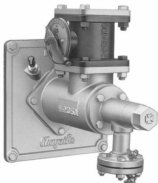
省エネ型汎用ガスバーナの代表機種です。当社独自のスロートミクス方式で、しかも高温予熱空気を効率よく活用。燃焼量や空気予熱温度が変化しても、低空気比燃焼を持続します。効率的な燃焼システムで、大幅な燃料節約を実現します。
