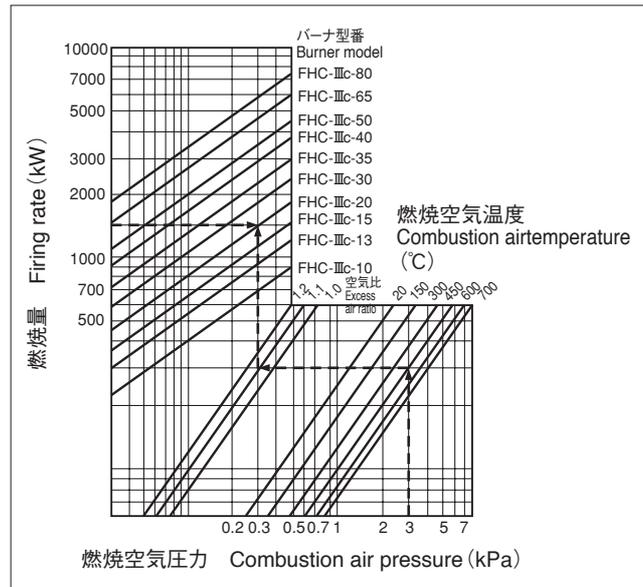
燃焼空気圧力、燃焼空気温度、空気比、燃焼量からFHC-Ⅲc型低NOxバーナの型番を選定する場合は左図をご利用ください。
