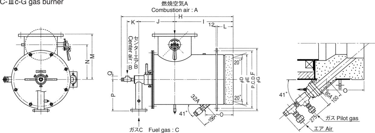
(ガス焼きバーナの取付寸法) Gas burner
