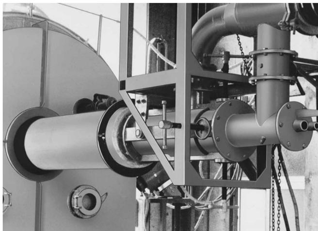
火炎の着火性と安定性に優れたバーナで、火炎長さを調節することにより温度分布を変えることができます。バーナ、架台、操作機器、安全操作盤などをコンパクトにまとめたユニットタイプです。
