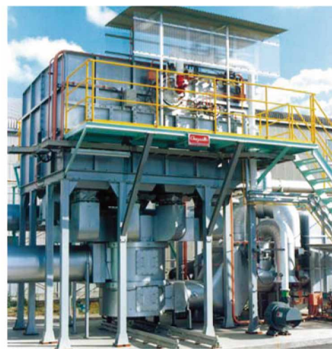
▲回転式蓄熱脱臭装置 [230 m 3 /min (normal)]
