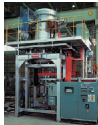
ガス圧高温炉
