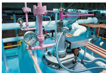
炉内設置型RXガス発生機 "CRG®-RC"
