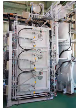
インライン用(小ロット型)真空浸炭炉 コンパクトファルコン®
