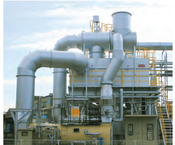
回転式蓄熱排ガス処理装置 (R-RTO)
