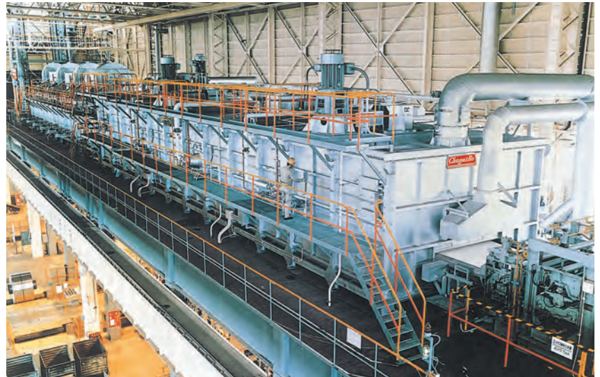
フロータイプアルミストリップ連続焼鈍ライン (AL-CAL)
