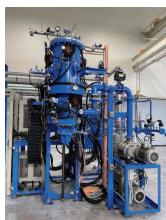
二次電池素材熱処理設備
