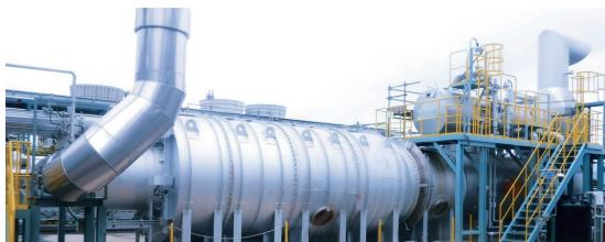
電炉向け排ガス処理設備（イメージ）
