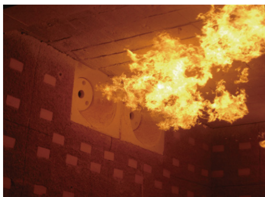
図6. 鍛造加熱炉用酸素バーナの長炎
